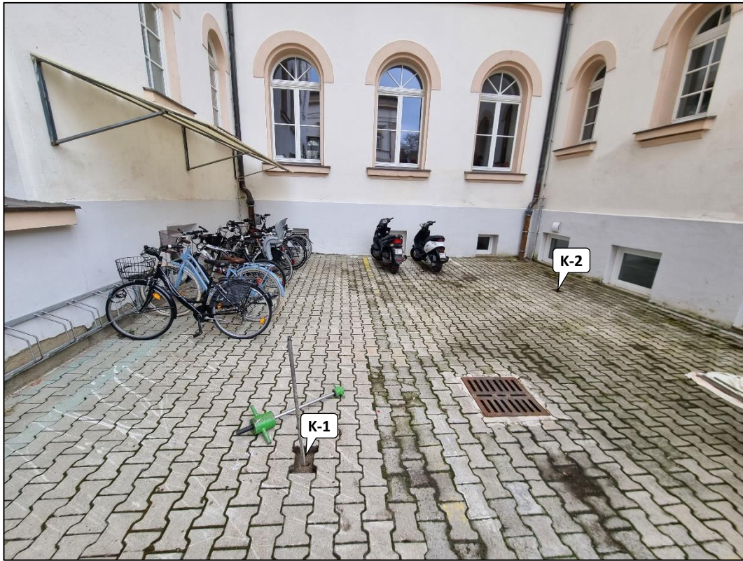
Slika 1: Območje predvidenega dvigala in DPL sond (Foto: 13.1.2023)
